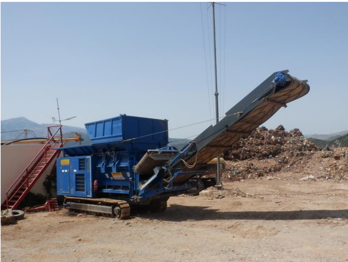
Εικόνα 4: Τεμαχιστής ογκωδών απορριμμάτων Φο.Δ.Σ.Α Βόρειας Πεδιάδος Α.Ε. ΟΤΑ
